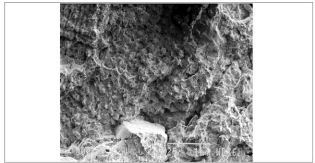
شکل ۸) ساختار دندریتی و ترک های مرزدانه ای
