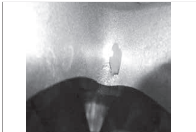
شکل ۱) عیب کشیدگی در قالب فلزی
