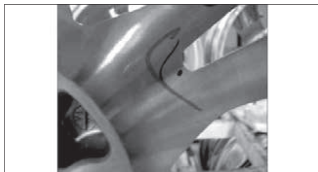
شکل ۹) عیب حفره گازی محبوس شده در قطعه
