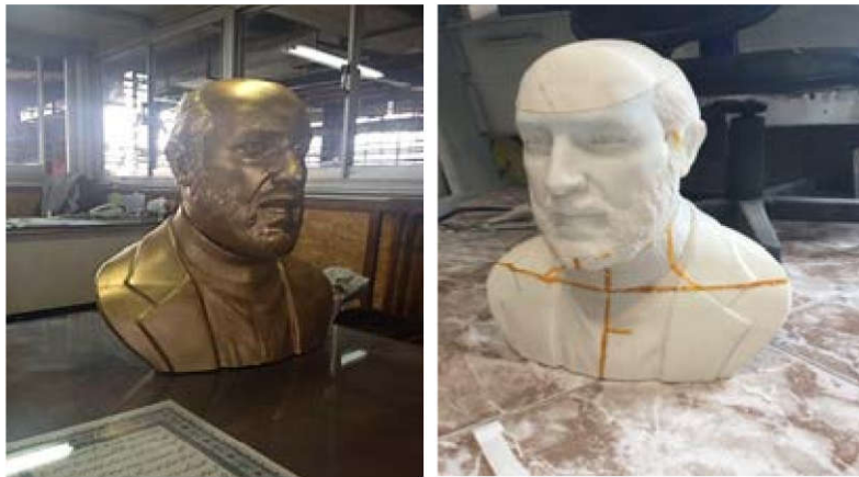
شکل ۴) مدل ۲D Printing قبل و بعد از مونتاژ و پتینه کاری از جنس پلاستیک ABS
