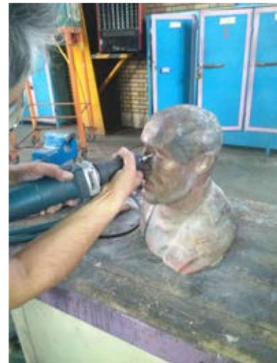
شکل ۹) مراحل تمیز کاری و پولیش و پرداخت کاری تندیس ریخته شده.
