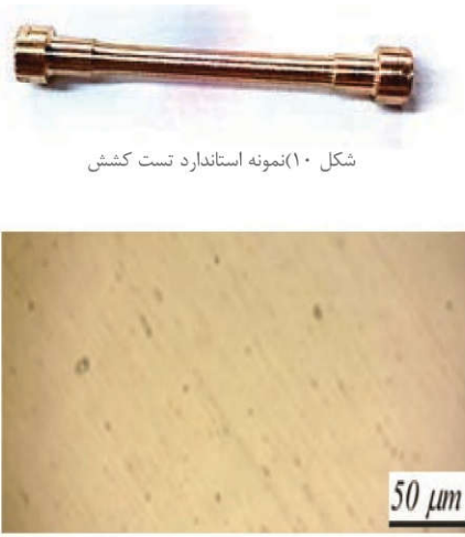
شکل ۱۱) ساختار میکروسکوپی برنز ریخته گری شده
