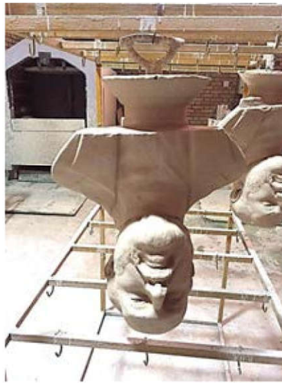
شکل ۹) دوغاب دهی، شن پاشی، و خشک کردن در محیط با رطوبت ۶۰٪ و دمای ۲۲°C
