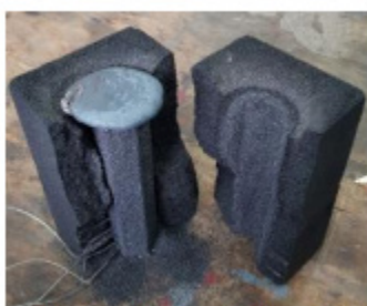
شکل ۱۱) یک نمونه ریختگی برای مطالعه سرعت سرد شدن ب صورت تابعی از فاصله سطحی با مبرد، همراه با تصویر محل استقرار ترموکوپل ها
