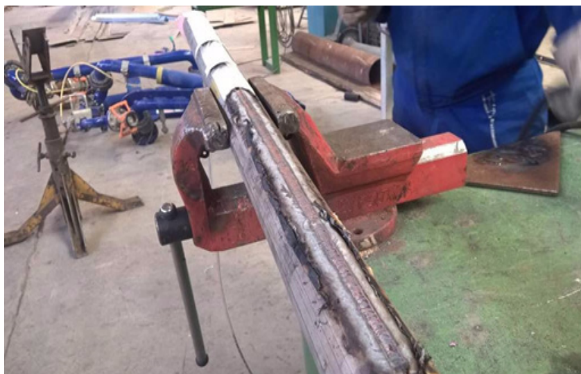
شکل ۳) تصویر لوله جوشکاری شده قبل از تمیز کاری
