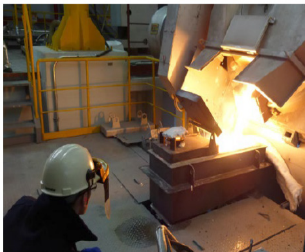
شکل ۹) اتمایزر با ظرفیت ۵ تن در حال کار؛ فلز مذاب از ذوب کننده چرخشی به داخل تاندیش ریخته می شود تا اتمایزر را تغذیه نماید [۲]
