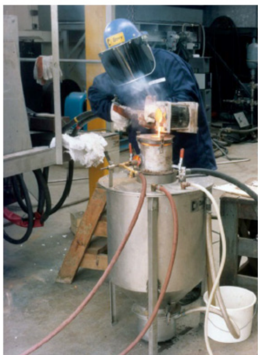
شکل ۱۳) یک مذاب تهیه شده کوچک که به داخل اتمایزر پنج کیلوگرم ریخته می شود [۲]
