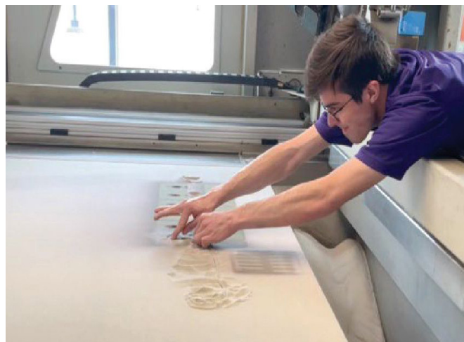
شکل ۴) قرارگیری سنسورها و کابل‌ها در میان بلوک‌ها، در طول زمان انقطاع پرینتر
