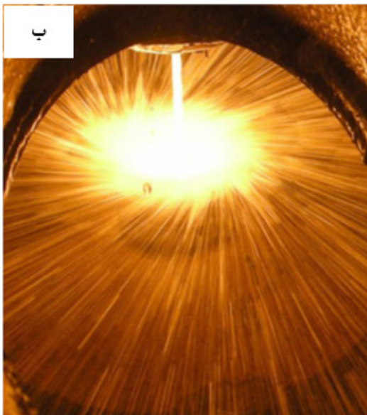
شکل ۱۷) الف: کوره ذوب ۲/۱ تن در حال تخلیه به اتمایزر با سیستم کوئچ آب و ب: کاپ حین کار با ظرفیت تولید پودر ۵۰ Kg/min
