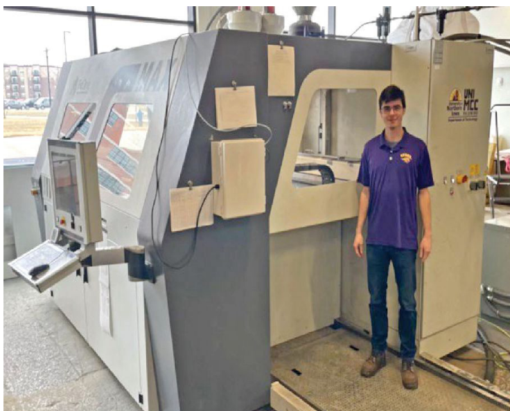
شکل (۱) دستگاه Exone پرینت ماسه در دانشگاه Northern Iowa
