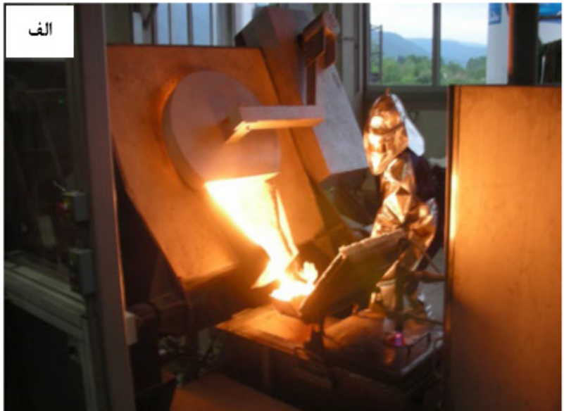
شکل ۱۷) الف: کوره ذوب ۲/۱ تن در حال تخلیه به اتمایزر با سیستم کوئچ آب و ب: کاپ حین کار با ظرفیت تولید پودر ۵۰ Kg/min
