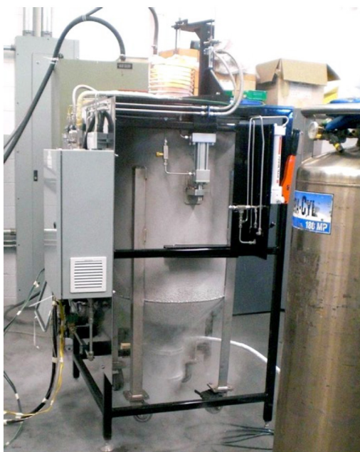
شکل ۷) یک سیستم اتمیزاسیون کوچک گازی دارای کوئچ با گاز مایع در محفظه آن [۱].
