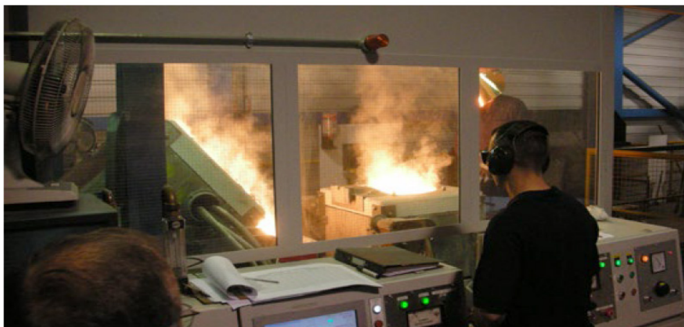
شکل ۱) یک سیستم اتمایزینگ گازی با ظرفیت کوره ۲۵۰ kg با قابلیت جلوگیری از تشکیل پیرا ذرات [۱]
