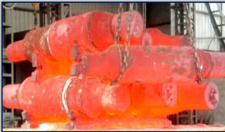
شکل ۲) عملیات حرارتی غلتک های فولادی ریخته گری (فولاد هایپروتکتوئید، نوع آدامایت)
